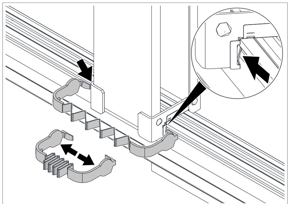
**Abb. 43:** Demontagewerkzeug ansetzen
