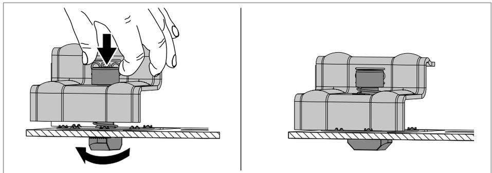
**Abb. 30:** Gleitmutter verkanten
