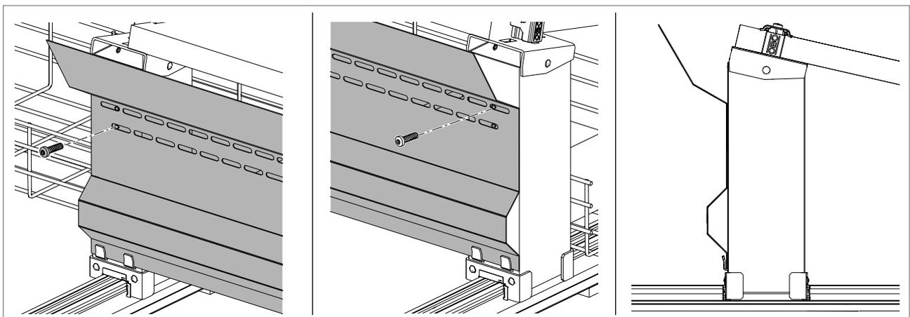
**Abb. 39:** Windschutzblech anschrauben
