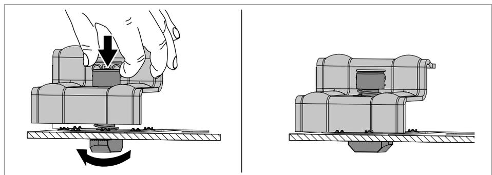
**Abb. 34:** Gleitmutter verkanten
