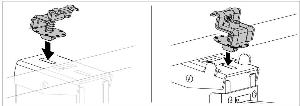
**Abb. 32:** Endklemmen mit Federn in Langlöcher einsetzen
