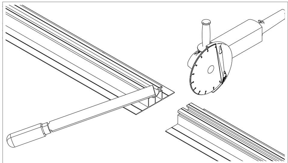
Abb. 5: Trägerprofil ablängen
